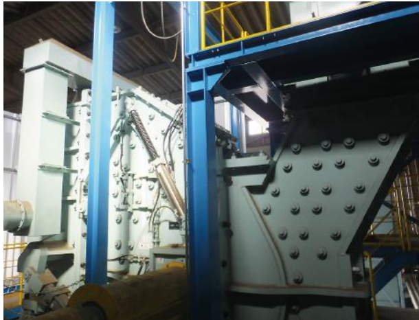
雑品処理に特化した破砕機「スーパーシュレッダー」
